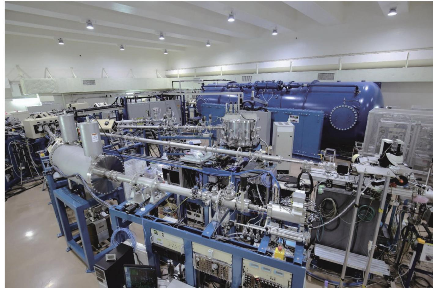
表紙写真 : 2015 年度に稼働を開始した筑波大学 6MV タンデム加速器とビーム輸送系。後方の青色横型タンク (全長 10.5 m、直径 2.74 m) 内で最大電圧 6 MV (600 万ボルト) を発生し、これによる静電加速で周期律表のほとんどの原子種のイオンビームを広いエネルギー範囲で提供可能です。加速器質量分析 (AMS)、物質のイオンビーム分析、放射線耐性試験、原子核実験などに利用されます。
