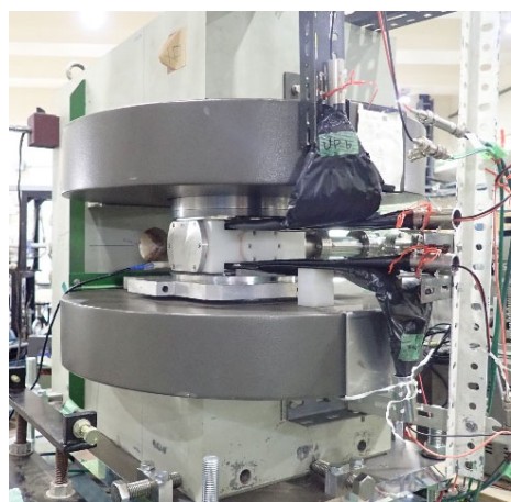
図3: (左)核モーメント測定のセットアップと(右)測定結果 (矢印は ^{29}\text{P} と ^{25}\text{Al} の磁気双極子モーメントに対応する)
