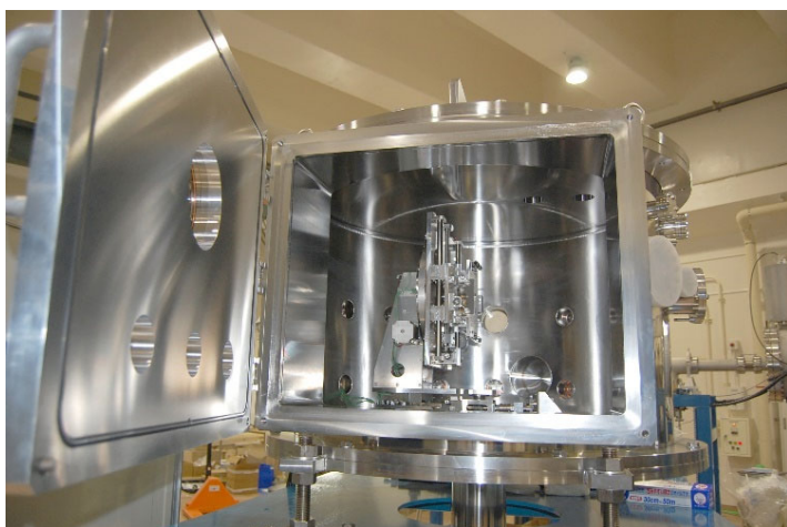
図1: 宇宙利用半導体素子等のイオンビーム照射実験用の真空散乱槽(直径1 m、高さ0.7 m)。内部にはA5判の面積を走査できるターゲット駆動機構、ターンテーブル、スリットなどが取付けられている。
